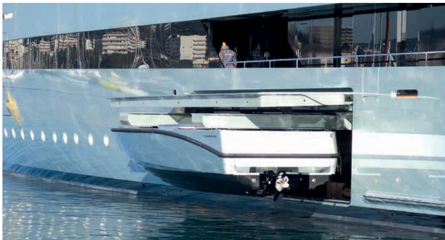
Für eine Sonderlösung baute das Unternehmen ein einfahrbares Kabinendach für einen auf Maß gebauten Tender mit einem langen Limousinen-Rumpf
